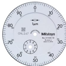
Skala jednokierunkowa (Podwójna szerokość działek)
